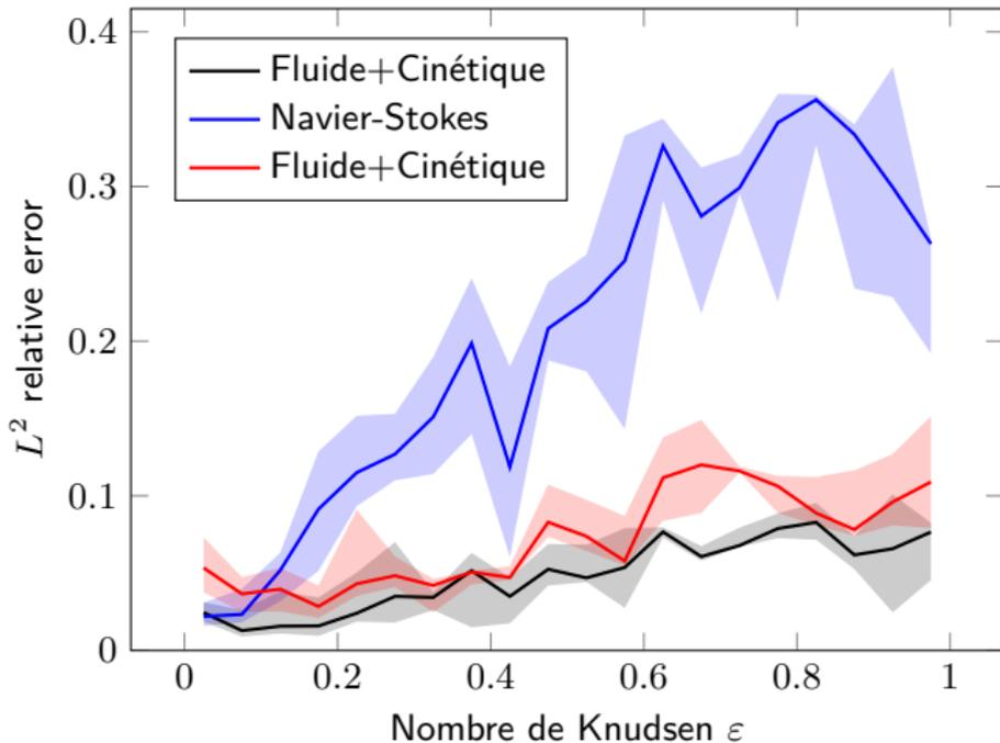
*L'erreur du modèle "Fluide+Réseau" augmente de façon similaire à celle du modèle "Fluide+Kinétique". Dérive de l'erreur expliquée par des problèmes numériques ?*
